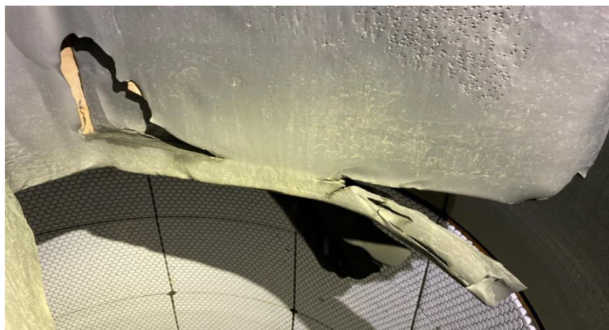
2.1 Сурет - ИмPELLердің резеңкелі қаптамасының (гуммировкасының) тозуы және қабыршақтануы.
