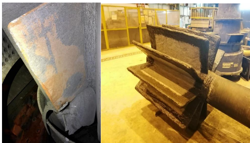
2.7 Сурет - Резеңкелі жабынды импеллердің тозуы
