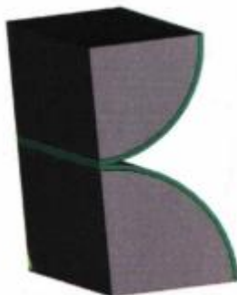
4 (б) Сурет - Біліктердің үш өлшемді геометриялық байланыс моделі
