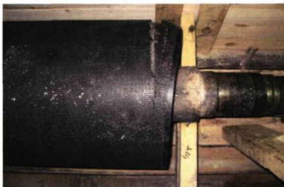
4.16 Сурет - Шекті әсерлерге байланысты импеллер білігінің жабынының бөлінуі
